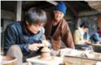
上：ろくろを回しながら、茶碗の形に整えていく 中：2種類の釉薬がかけられた器（手前） 下：茶碗の高台を削る峻さん（左）を見守る4代目乾馬さん（中央）
